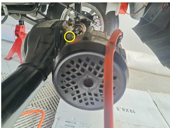
Irrota moottorin kiinnityspultti. (hylsy 8 mm)
