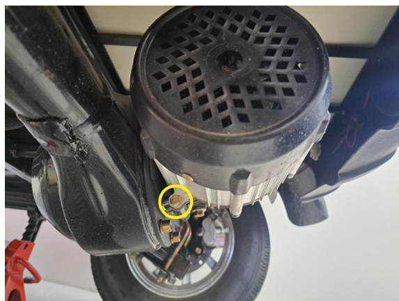
Irrota moottorin kiinnityspultti. (hylsy 8 mm)
