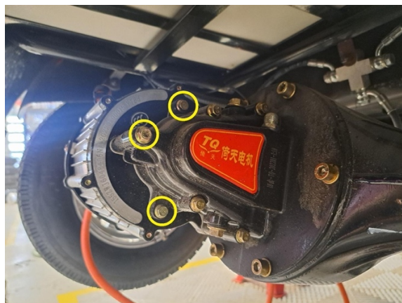
Irrota moottorin kiinnityspultit. (hylsy 8 mm)
