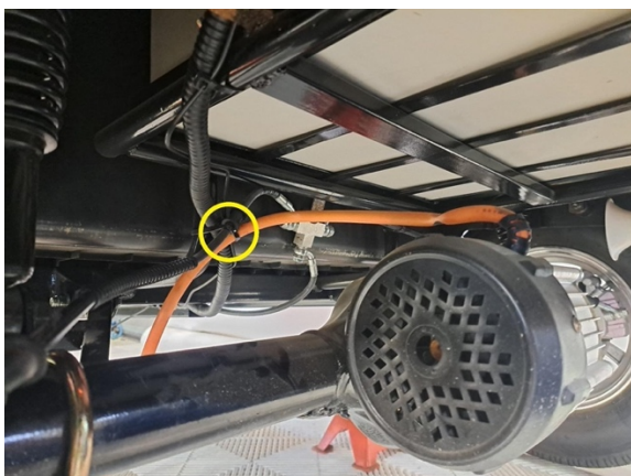
Katko loput moottorin johtoa kannattelevat nippusiteet. (sivuleikkurit).
